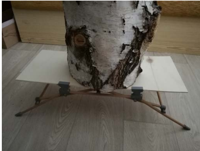
Obr. č. 21, Závažový test modelu 1:2
