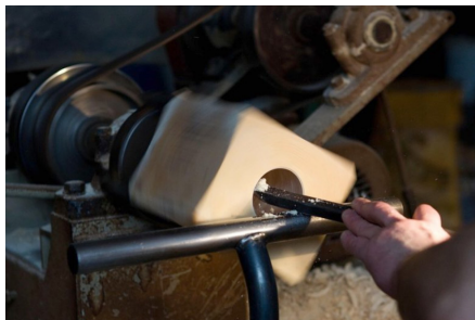
Obr. 12 Ukázka výroby dřevěné formy soustružením
