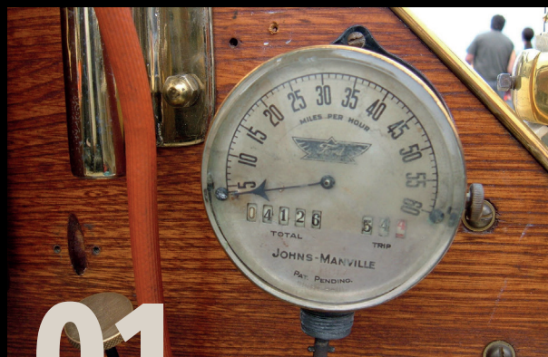
Rychloměr vozu Ford Model T Speedster z roku 1913
